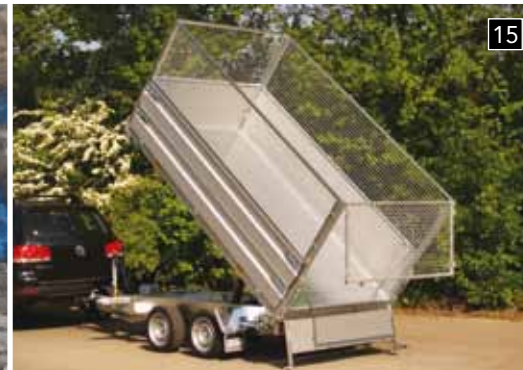
Photo 14 et 15: des ridelles surélevées en aluminium de 400 ou 500 mm de hauteur rehausses grillagées sur les ridelles rehausses de ridelles en aluminium supplémentaires de 300 mm rehausses de ridelles en aluminium supplémentaires de 400 mm, articulé en haut et une filet de chargement (à petites mailles).
