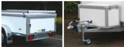
▲ Coffre avant sur timon (multiplex/profilés d'aluminium), dimensions extérieures 990x405x690 mm (également livrable dans d'autres dimensions).
