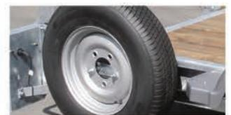
■ Roue de secours (avec fixation pour PEGD 35 et 40 seule pour PEGD 30)
