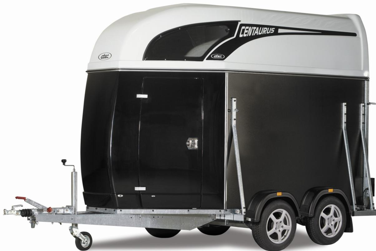
Outre l'acier du châssis, les principaux matériaux de nos vans sont le bois et le polyester. Le cœur des parois est composé de multiplex finlandais. Celui-ci est fabriqué à partir de bois de bouleau à croissance lente qui le rend plus solide que n'importe quel autre matériau pour panneaux.
