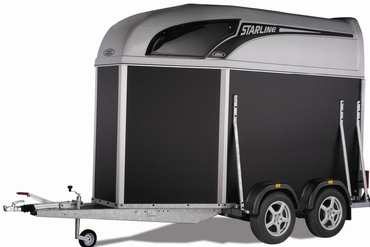
Pour la structure des vans en bois, les parois sont laminées et recouvertes de PPL, une couche synthétique spéciale de protection. Cette couche est spécialement conçue pour la structure du van et est donc également résistante aux UV. Les panneaux des parois sont disponibles en couleur blanche, grise et anthracite.
